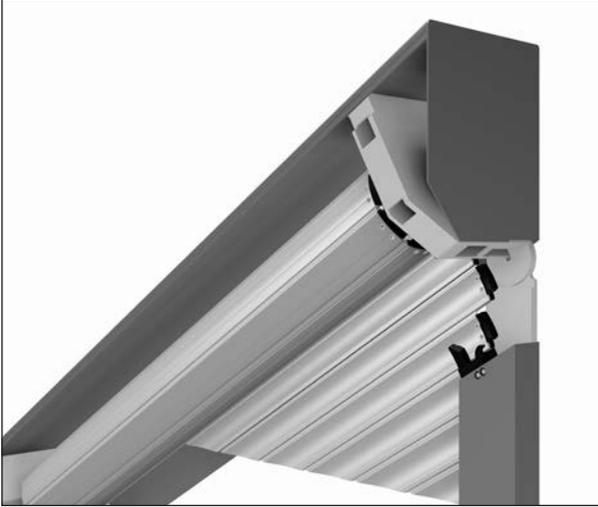
Führungsschiene niedere Seite auf den Steckzapfen bündig aufschieben.
