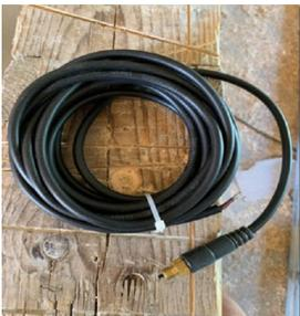
Kabel für Abrollsicherung - kann durch !! Elektrofachkraft !! verlängert werden
