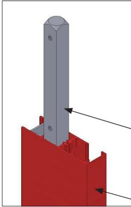
Führungsschiene mit vormontiertem Steckbolzen in die Blende einführen und über die Innensechskantschrauben M6x20 mit der Blende verschrauben (Bild 2). Der Raffstore ist bereits in der Blende vormontiert. Das Schnellmontagesystem ist optional ohne Blende erhältlich. Hier erfolgt die Befestigung der Führungsschiene über die Winkelendstücke (Bild 3)
